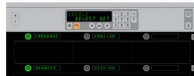
Der Schrank ist mit der Anzeige *LOCALE* abgebildet. Neben *SPRACHE* befindet sich die aktuelle Sprachauswahl; neben *CELSIUS* befindet sich der aktuelle Temperaturbereich.
