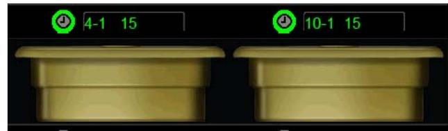
Im Short-Modus der Anzeige werden der Produktname und die verbleibende Haltezeit durchgehend angezeigt. Einige Produktamen werden abgekürzt.
