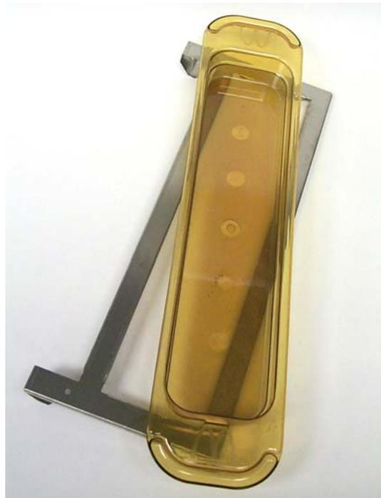
Die Grillklammer wird am Grill angebracht und hält das gegrillte Produkt in einem UHC-HD-Tablett, wodurch die Übertragung zum Halteschrank erleichtert wird.
