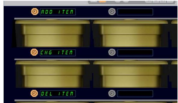
Wenn die Produktauswahl in den Programmiermodus genommen wird, wird *EL HINZF, EL ÄND* und *EL LÖSCH* angezeigt.
