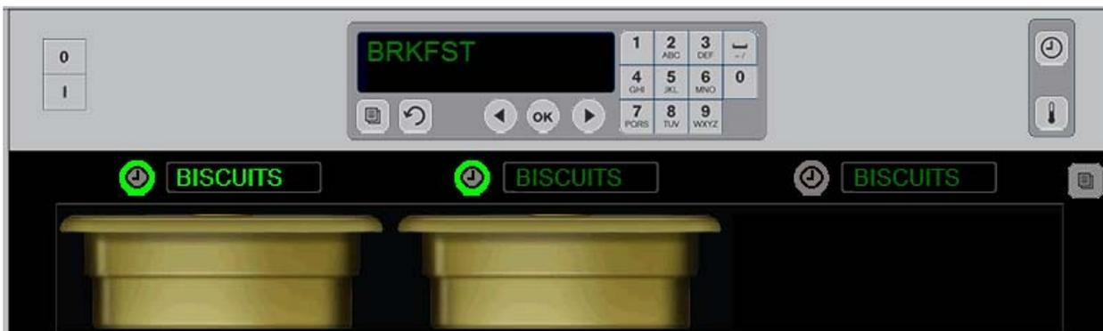
Eine erleuchtete Taste und ein erleuchtetes Menüobjekt kennzeichnen die zuerst zu verwendende Reihenposition. Eine erleuchtete Taste in einer Reihenposition weist darauf hin, dass sie aktiv ist, gibt jedoch nicht die Position mit der geringsten verbleibenden Haltezeit an. Der Menüname wird heller, wenn er zur Position mit der kürzesten verbleibenden Haltedauer wird.
