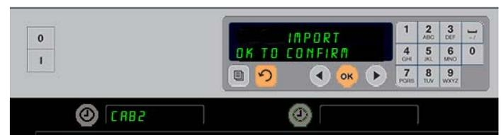
Die Dateinamen der Gehäusekonfigurationen auf dem Flash-Laufwerk werden beim Importieren einer Konfiguration (oben) am Gehäuse angezeigt. Eine Konfiguration wird durch das Drücken der benachbarten Zeitgebertaste ausgewählt. Dieser Dateiname erscheint in der oberen linken Position (untere Abbildung). Alle Zeitgebertasten werden gelöscht und alle anderen Zeilenpositionsanzeigen sind leer.
